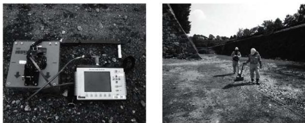
図 8 400MHz アンテナとコントロールユニット (左)・作業風景 (右)
