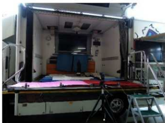
図2 起震車による転倒実験
