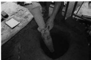
写真10 繋げて装着した大口径羽口
