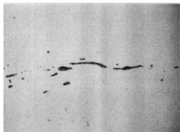
非金属介在物：ウスタイト (FeO) ×200 (低温還元直接製鋼法：塊煉鉄)
