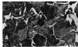
写真11 鈎状鉄製品(鉄15)の顕微鏡組織
