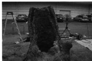
写真28 群埋文2号炉 操業後の断面
