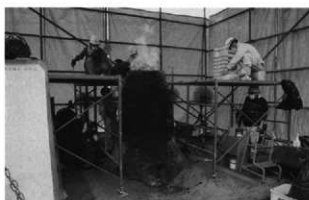
写真42 10:43 マツ炭1.0kg投入、砂鉄0.5kg投入。
