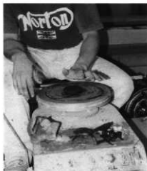
図13 ①底部に相当する円盤をつくる
