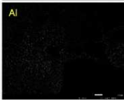
第 223 図 ガラス質滓 (400) の顕微鏡写真・EPMA 調査結果
