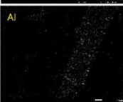
第 221 図 鍛冶滓 (250) の顕微鏡写真・EPMA 調査結果
