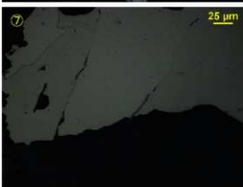
写真図版 C 製錬滓の顕微鏡組織
