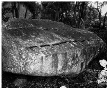
② 天狗岩丁場の種石 （角石用材の母岩、二条の矢穴列の間隔は 95 ~ 100cm）
