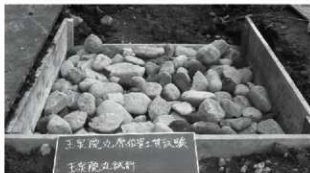
②中詰め状態 手詰めで充填
