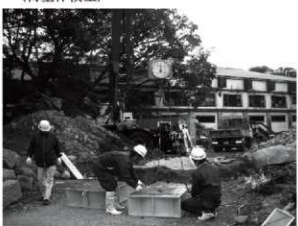
写真 6-11 現場簡易一面せん断試験 実施状況
