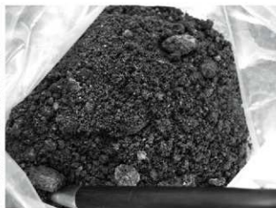
写真3-4 現場密度試験採取試料
