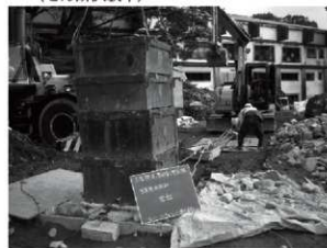
写真 6-11 現場簡易一面せん断試験 実施状況
