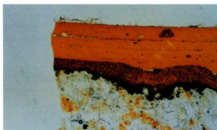
Cにおける塗膜層断面 (拡大)
