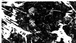
photo. 1 鉄塊系遺物の顕微鏡組織 (82%)
