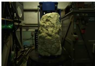
写真232 X線CT撮影状況
