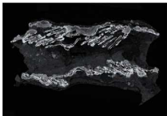
写真240 2号甲C T撮像(巻込み部縦断面)
