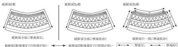
図12 破断面による破砕鏡の分類
