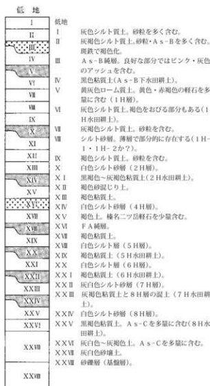
第241図 五目牛清水田遺跡 低地部基本土層模式図
