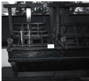
写真13 鈴木組喜多方製糸所再機工場の絵はがき(部分) 上部に手動切斷計数器が並び、それぞれ異なった数値を示している
