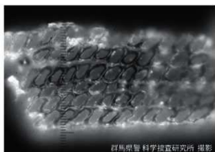
写真7 試料1中木片繊維方向の横断面生物顕微鏡写真
