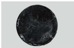
写真4 10建No143桶底板内側。矢印は試料採取地点
