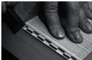
写真1 留形隠蟻組接ぎで箱を作る
