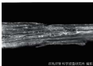
写真8 試料1中木片繊維方向の縦断面生物顕微鏡写真
