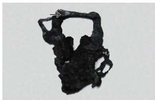
写真3 13建No120②溶接部。矢印は分析地点
