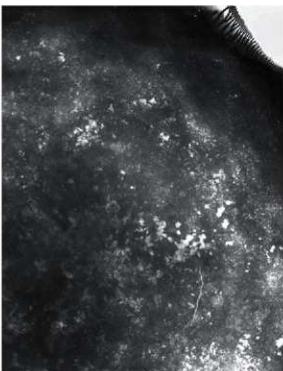
銅製容器 底部内面(右側)のX線写真
