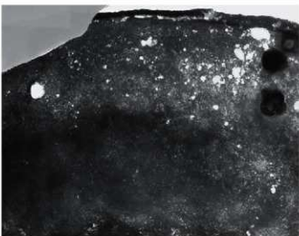
銅製容器 鋸留めと3孔間の内面X線写真
