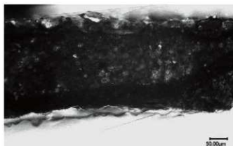
写真25 本試料における固化塗膜の断面観察
