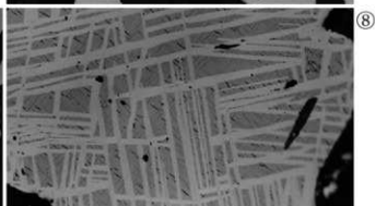
Photo.14 炉内滓 (含鉄)・砂鉄の顕微鏡組織
