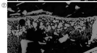
Photo.10 梔形鍛冶滓・再結合滓の顕微鏡組織
