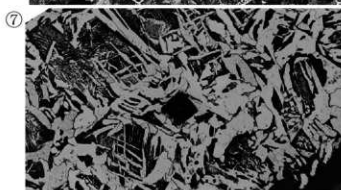
Photo.11 鉄塊系遺物の顕微鏡組織
