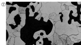
Photo.5 炉内滓 (含鉄) の顕微鏡組織
