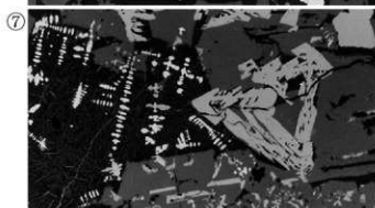
Photo.4 炉内滓 (含鉄)・炉底塊 (含鉄) の顕微鏡組織
