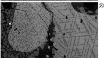
Photo.1 砂鉄焼結塊・流出溝滓の顕微鏡組織
