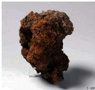
炉内滓 (か壁付き、含鉄)
