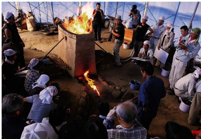
愛媛県今治市佐夜ノ谷遺跡の箱形炉を復元した製鉄実験
