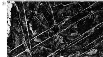
Photo. 10 鉄塊系遺物の顕微鏡組織
