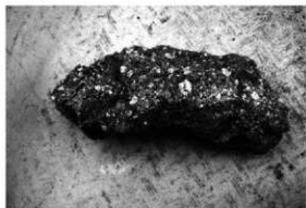
第42図 箱形炉の製鉄実験で炉壁と炉床土の間に生成した滓(藤井勲氏提供)
