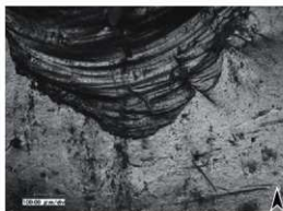
6 x40 先端部剥離面の内部
