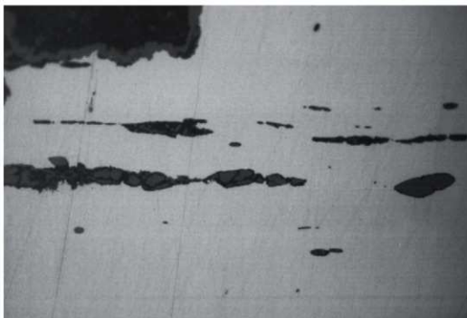
非金属介在物：灰かんらん石 ( \text{Ca} \cdot \text{Fe} ) \text{O} \cdot \text{SiO}_2 と少量ウスタイト ( \text{FeO} ) ×500
