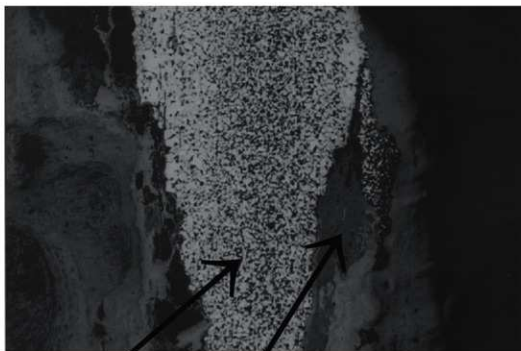
心金：フェライト・マルテンサイト 皮金：局部的遺存で金属鉄残なし 高炭素鋼？ ×50
