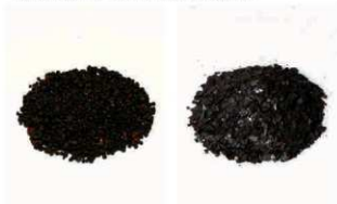
粒状滓 粘土汁と鉄の酸化物が飛散して球状化。 鍛造剥片 鉄素材の表面から剥離した酸化被膜。
