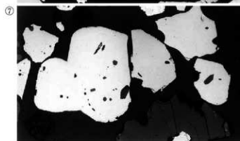
Photo.1 炉壁・砂鉄の顕微鏡組織
