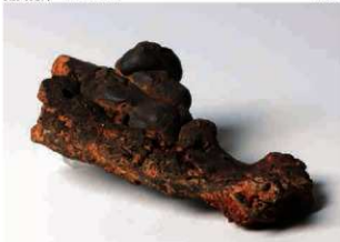
流出溝滓 扁平で気孔が多く、下面は錘状。 No.58
