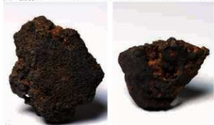
砂鉄焼結塊 砂鉄が還元しないまま結合した塊。 No.47 マグネタイト系遺物 縦着が強く、青黒い。 No.129
