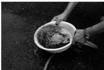
水流による砂鉄の分離
