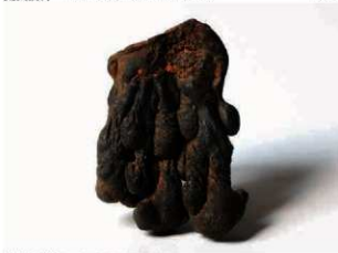
炉内流動滓 細い流動単位が重層する。 No.147
