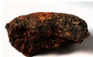
炉底塊 (炉壁付き) No.158 炉壁(上)に沿って生成された炉底塊(下)。上から撮影。
