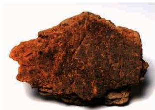
炉壁 (上段) 内面はわずかに発泡。 No. 3
