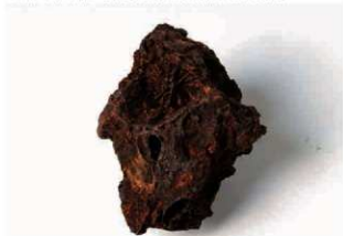
炉内滓(内面) No.165 大型の木炭痕(上)と錆色の目立つ典型的な炉内滓。
