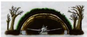
第49図 1号木製掩体壕の復元イメージ図 永山1号掩体壕の調査成果を基に、当時証言を含めて2007年山下完二氏が作製
