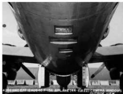
写真 75: 写真偵察機 F13 腹部の偵察カメラ類の様子（工藤洋三氏提供）
