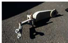
写真10: 陸軍四式戦闘機疾風の主脚下部部品で「トルクリンク」
