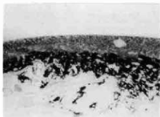
— No.5 漆椀 高台端部の 断面写真 (×200)
