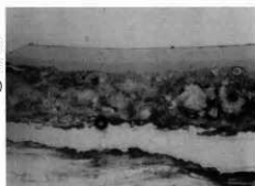
← No.1 漆碗 外面の断面 写真(×100)
