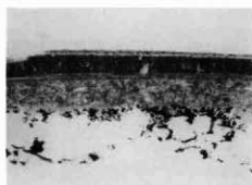
— No.4 漆椀 口縁端部の 断面写真 (×200)
