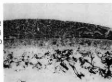
← No.3 漆碗 口縁端部の 断面写真 (×200)
