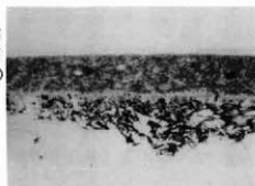
← No.2 漆碗 外面の断面 写真(×200)
