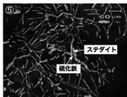
Photo.5 炉内滓 (含鉄) のマクロ・顕微鏡組織
