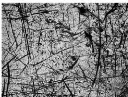
5. 実験試料1-スポット4 摺り合わせ100回 変化無し x40
