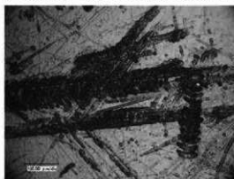
8. 石器No.1-10-7の表面 C字状のリング・クラックの連続 (落射型レンズ) x90
