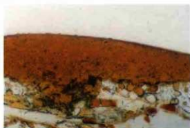
漆器皿(木器 No.23) 塗膜断面(200倍)
