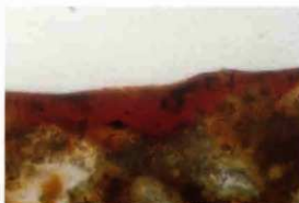
付着土器(須志器 No.81) 塗膜断面(200倍)
