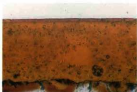
漆器皿(木器 No.23) 塗膜断面(500倍)
