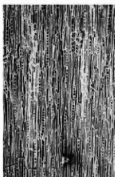
6b クリ (接線断面) No.42 bar : 0.5mm
