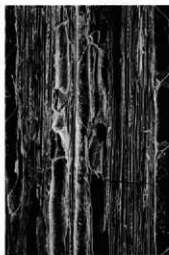
2b ヤナギ属 (接線断面) No.13 bar: 0.1mm
