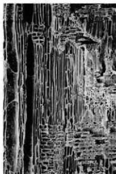
4c コナラ節 (放射断面) No.60 bar : 0.1mm
