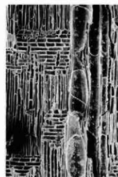
6c クリ (放射断面) No.42 bar : 0.1mm
