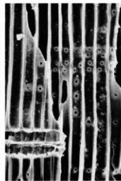
1c アスナロ (放射断面) No.81 bar: 0.05mm
