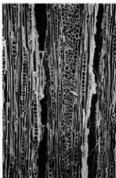
4b コナラ節 (接線断面) No.60 bar : 0.1mm
