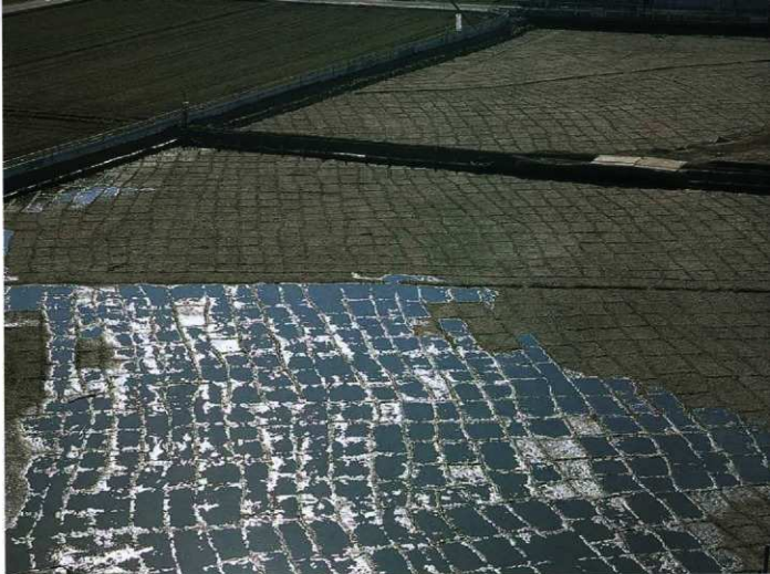
極小区画水田における流水実験 (手前から奥へ流下し大畦畔でストップ。大区画内が吸水するまで、下位の大区画へ流下しない)
