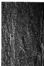
5 b コナラ節 (接線断面) bar: 0.1mm
