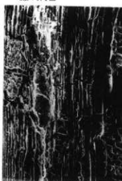
6 c クスナギ節 (放射断面) bar: 0.1mm
