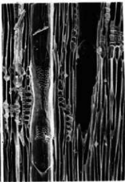
2 c ヤナギ属 (放射断面) bar: 0.1mm
