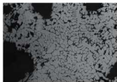
顕微鏡組織写真 No.3-1 (炉底滓)
