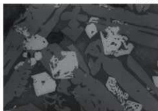
顕微鏡組織写真 No.2-2 (椀形滓)
