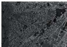
顕微鏡組織写真 No.1-1 (椀形滓)
