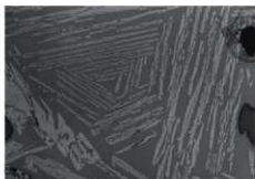
顕微鏡組織写真 No.5-1 (鉄滓2)
