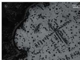
photo.5 銅塊(MNY-3)の顕微鏡組織
