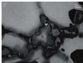
photo.1 銅塊 (MMY-1)の顕微鏡組織
