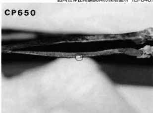
4 (資料番号1-4) 銅製水瓶舌 (中央)。 3より深い金底部を採取 (CP650)
