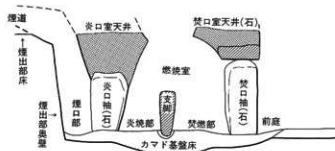
第11図 カマド模式図縦断面図
