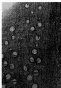
20a, アカガシ亜属(横断面)実測4-799 bar: 0.5mm
