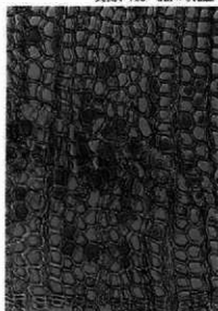
5 a, アカマツ(横断面)実測4-876② bar: 0.2mm
