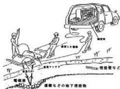
図207 地下レーダー探査の測定概念図
