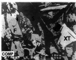
図12 Na1 鉄滓の組織観察結果
