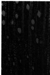
73a.ガマズミ属(横断面) 実測4-32 bar:0.2mm
