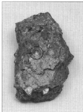
写真3 銅鏽付着状況(○内銅鏽)
