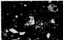
1. I H-051の偏光顕微鏡写真(上:単ニコル,下:直交ニコル)。黄褐色から褐色の基質中に、楕円形の火山岩石片(中央右)、暗褐色岩石片(左中央)、石英破砕片、斜長石破砕片、普通輝石、不透明鉱物などが散在している。スケールは0.5mm。
