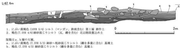
第11図 基礎及び基礎外周断面図(南側)
