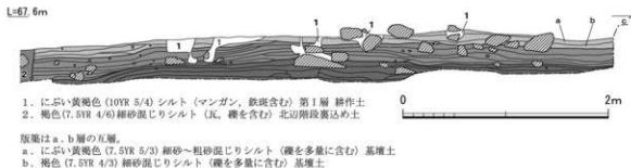
第11図 基礎及び基礎外周断面図(南側)
