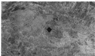
Photo. 7 含鉄滓の顕微鏡組織
