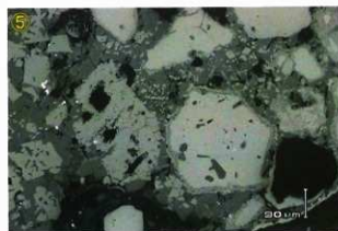
Photo.4 流動滓・炉底塊の顕微鏡組織
