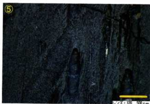
Photo.7 炉内滓(含鉄)・木炭の顕微鏡組織
