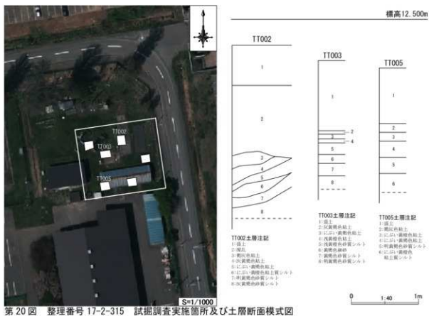
第20図 整理番号 17-2-315 試掘調査実施箇所及び土層断面模式図
