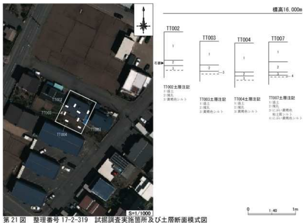
第21図 整理番号 17-2-319 試掘調査実施箇所及び土層断面模式図
