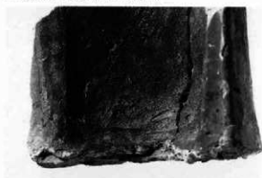
4. 鐘瓦(男瓦部)背面接合状態
