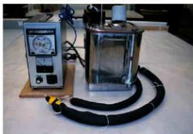
蒸気発生装置
