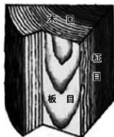
図3-1 木材の基本的3断面
