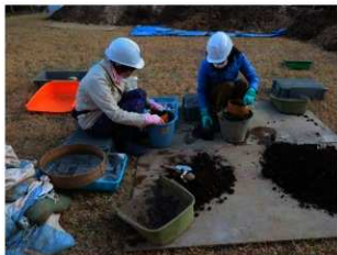
写真IV-3 土壌サンプルの先行洗浄作業
